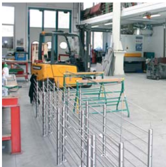
Gli elementi prefabbricati e assemblati consentono un rapido montaggio in loco
