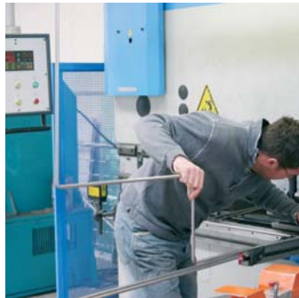
Mit Hilfe unserer modernen Abkantpresse lassen sich genaueste Winkel biegen
