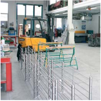
Vorgefertigte und zusammengesetzte Elemente erlauben eine rasche Montage vor Ort
